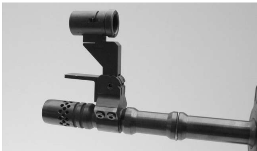
Bild 11: Kornträger als Visierverlängerung zu Stgw 57 (Laufmontage), diverse Fabrikate
